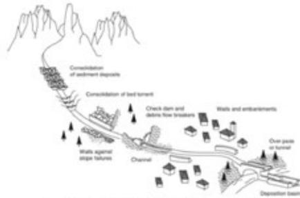
Figura 10 Propuesta de estructuras para contención de flujos de lahar
