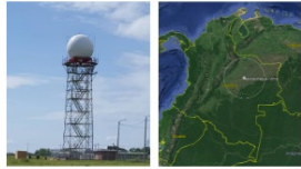
Figura 4. Radar meteorológico de Carimagua. A la izquierda foto del instrumento en sitio, a la derecha cobertura técnica del radar con un radio de 240 Km.
