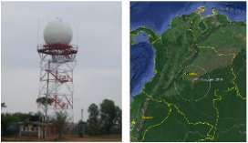
Figura 1. Radar meteorológico de San José del Guaviare. A la izquierda foto del instrumento en sitio, a la derecha cobertura técnica del radar con un radio de 240 Km.
